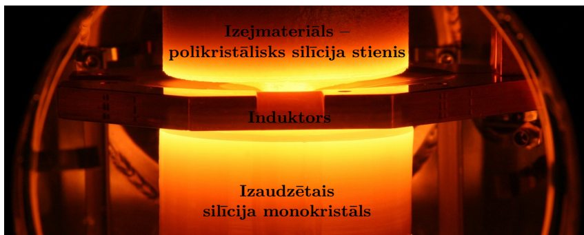
3. attēls. Skats caur iekārtas logu uz 4 collu kristāla diametra peldošās zonas procesu Leibnica kristālu audzēšanas institūtā. Izejmateriāla un monokristāla stienis tiek rotēts un bīdīts uz leju, indukcijas spoles pozīcija saglabājas fiksēta.
