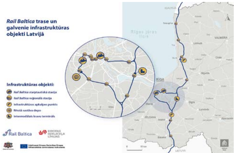
Katra infrastruktūras apkopes punkta kopējā platība plānota ap 16 hektāriem. Abos infrastruktūras apkopes punktos paredzēts izbūvēt 1435 mm platuma sliežu ceļus aptuveni 14 km garumā, kā arī pieslēgumus tuvumā esošajiem 1520 mm platuma sliežu ceļiem gandrīz 13 km garumā.
