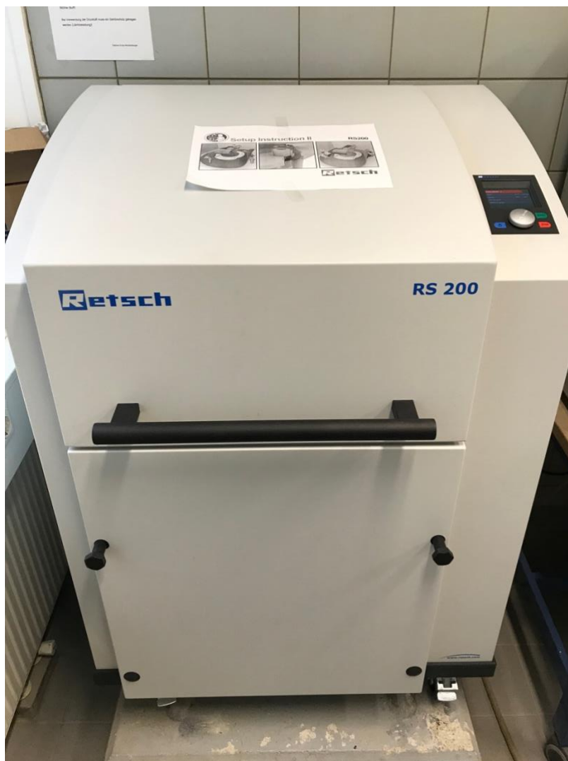
4.6. attēls. Planetāro dzirnavu iekārta Retsch RS 200 , kas izmantota paraugu pulverizēšanai.
