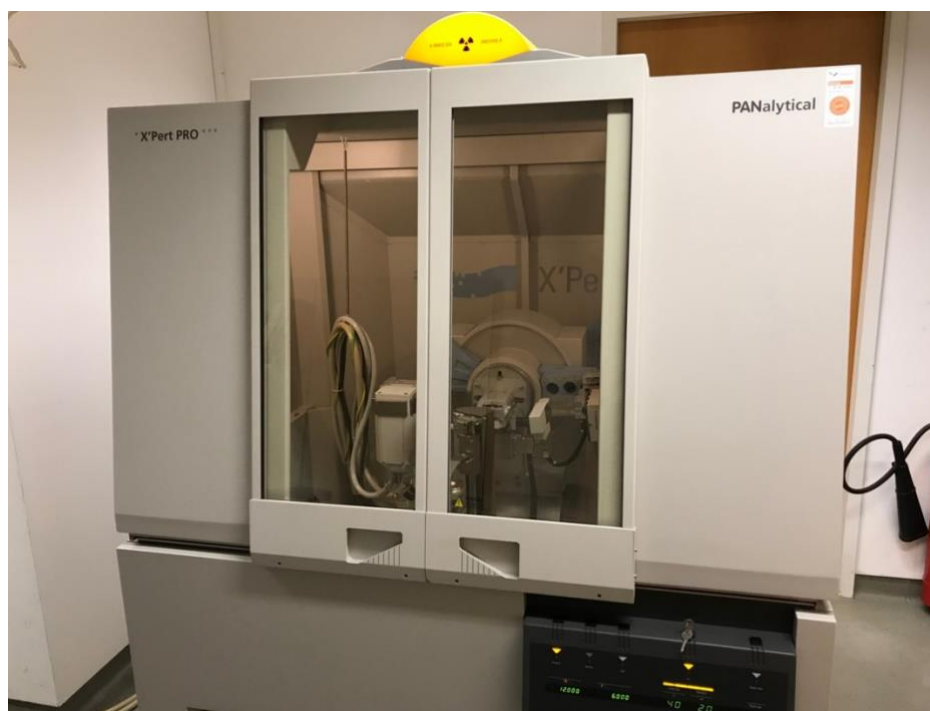
4.7. attēls. Panalytical X'pert Pro rentgenstaru difraktometrs Vīnes Universitātes, Ģeodinamikas un sedimentoloģijas centrā.
